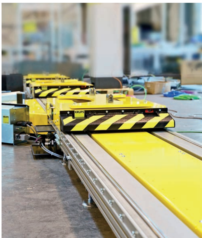
Systém eCart neobsahuje pohon, čím eliminuje potrebu údržby dopravnej dráhy a maximalizuje jej dostupnosť.
