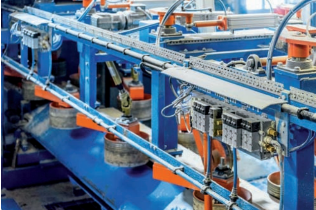
Flexibilné funkčné terminály CPX/VTSA s rôznymi modulmi zbernice od Profinet cez Ethernet/IP, ModBus až po DeviceNet sú mimoriadne odolné proti prášnému prostrediu pily.
