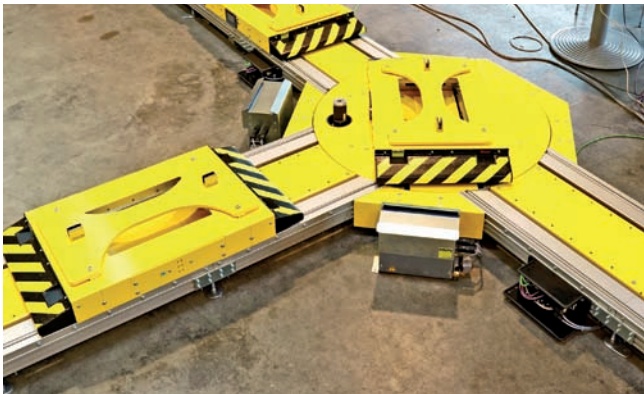
Na dorazoch a iných funkčných moduloch komunikuje systém eCart s vozíkmi cez NFC.
