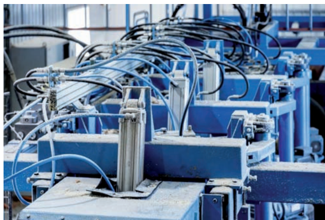
Preprava, upnutie, centrovanie: normalizované valce DNC a ADN odolávajú pilinám a hoblinám.
