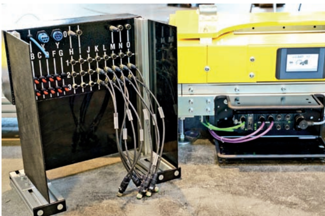
Pred a po: Riadiaca jednotka, ktorú vytvorila spoločnosť Krups (1.), fungovala dobre, ale v porovnaní s modulom TBEN-L od spoločnosti Turck (2.) bola podstatne väčšia a komplikovanejšia na inštaláciu a fungovala iba v sieťach Profinet.
